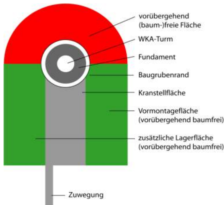
Abb. 14 Schema eines WEA-Standorts
